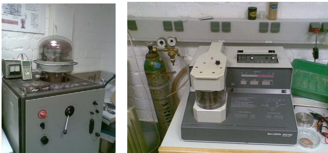
Abb 3. Vakuumpumpstände zur thermischen Verdampfung und zum Sputtern (Au / Pd)
